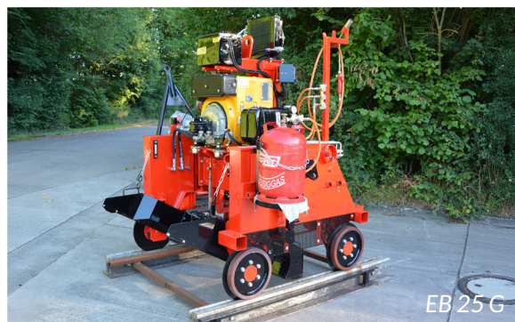
Unité de finition et épandeur de gravillons intégrés dans la voie
